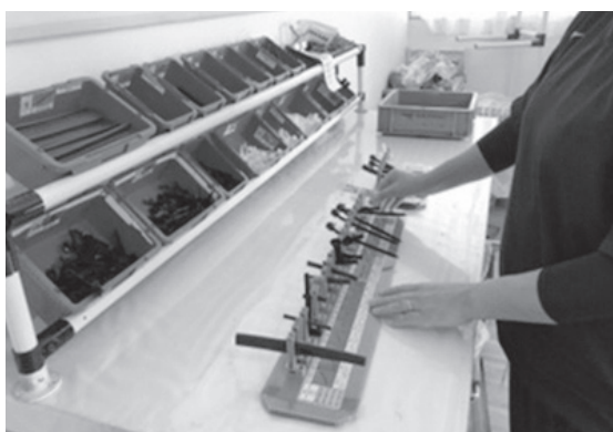
【構造化① ワイヤーハーネス部品準備作業と組立準備用治具】
