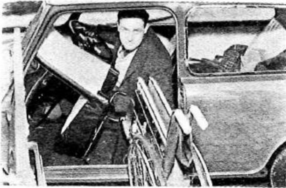
図 1 モーリスミニマイナーはドアが 90° 近く開く、フットレストが車の下に入り、アプローチに便利。しかもへりが低いので、車椅子を引き入れやすい 10) 。
