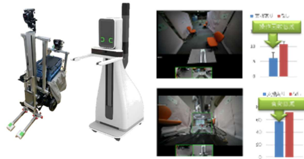
遠隔就労支援ロボット（2次試作機と展示用：製作中） と操作インタフェース
