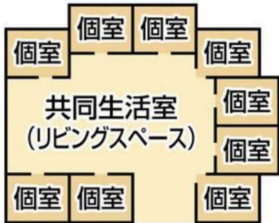
ユニット型個室
